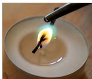
Zünden Sie das Teelicht an und halten Sie den Kupferdraht mit der Zange in die Flamme. Warten Sie, bis der Draht glüht, dann gehen Sie mit dem heißen Draht in eine der Kunststofffolien und halten den Draht, der nun mit Kunststoff belegt ist, wieder in die Flamme. Wenn sich die Flamme nun grün färbt, handelt es sich um PVC. Bei den anderen Kunststoffen bleibt die Flamme gelb. Eventuell stinkt es bei diesem Experiment etwas. Löschen Sie nun die Flamme.
